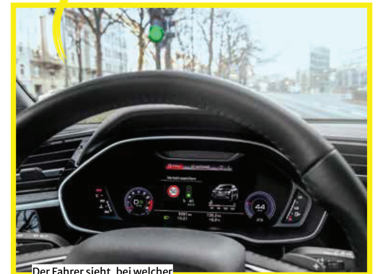
Der Fahrer sieht, bei welcher Geschwindigkeit er an der nächsten Ampel nicht anhalten muss.
